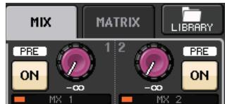
用 [TOUCH AND TURN] 旋钮调节发送电平。
