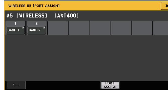
例如：将 Shure AXT400 的输出连接至 QL 调音台的 OMNI 1，并将信号分配至输入通道 1。
