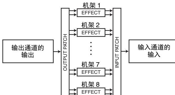
另外，您可以将内部效果器的输入和输出信号分配到一个所需通道的 insert-out/in（除了对于 ST IN 通道），这样使得效果器能插入该通道。
