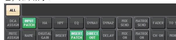
本插图中, 亮起成绿色的部分表示 INPUT PATCH、INSERT PATCH 和 DIRECT OUT 参数已经通过 INPUT PATCH 全局参数设置被设定为安全调用模式。
