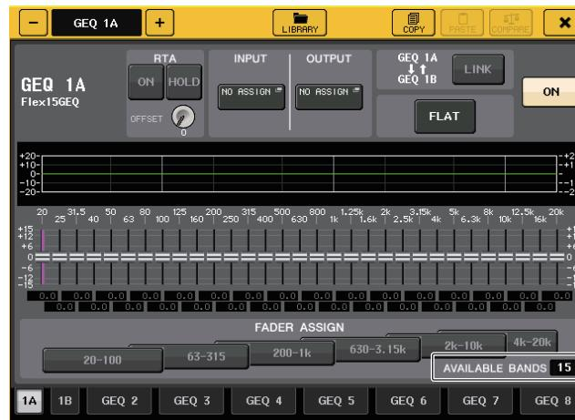
这个窗口与 31BandGEQ 的窗口相同，除了显示额外频段（最多 15 个）的实时号码的 AVAILABLE BANDS 参数框，额外频段可以受到当前 GEQ 所控制。
