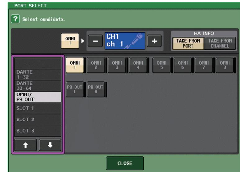
这可以将输出信号从 AXT400 分配至输入通道，同时可以从输入通道控制和监听 AXT400 的电平。
