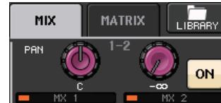
您可以关联两个奇 / 偶编号的相邻 MIX/MATRIX 总线。如果发送目标 MIX/MATRIX 总线被分配为立体声，两个相邻 TO MIX/MATRIX SEND LEVEL 旋钮的左侧旋钮会起到 TO MIX/MATRIX PAN 旋钮的作用。（如果 TO STEREO/MONO 窗口中选定了 BALANCE 模式，它将可以作为 BALANCE 旋钮进行操作。）
