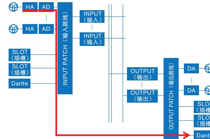
用 PORT TO PORT 功能，可以从后面板上的一个输入插孔将信号输出到 Dante 接口，无需经过调音台发送信号。这样，您就可以将 QL 调音台上的 I/O 插孔作为音频网络的 I/O 插孔使用。
