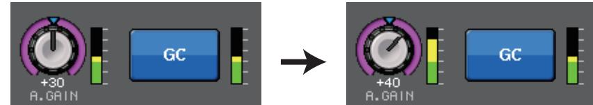
如果 FOH 调音台和监听调音台共享一个 I/O 设备，调节 FOH 调音台调音台上的模拟增益也不会影响监听调音台上的输入电平。音频网络中的信号会保持在一个固定的电平，因此尽可能高地增加模拟增益可以相应降低噪音并提高信噪比。
