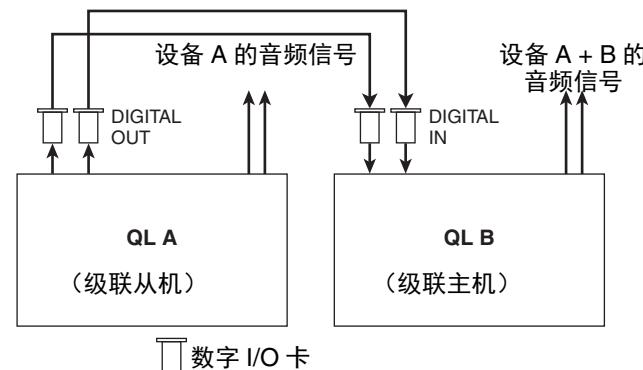
本实例中，可以从 MIX 总线 1-16、MATRIX 总线 1-8、STERO 总线 (L/R)、MONO (C) 总线和 CUE 总线 (L/R) 中选择，最多有 24 条总线可以共享，然后从 QL 级联主机发送混合的信号。(如果使用 2 个 16 通道数字 I/O 卡，所有总线都可以在各设备间共享。) 当为级联从机和级联主机进行所需设置时，级联从机的总线信号将经由连接至级联主机总线的插槽发送，并且两条总线的组合信号从级联主机输出。如果级联关联功能被启用，在任何一台 QL 系列调音台上所执行的特定操作或参数变更，都会被另一台 QL 调音台学习。
