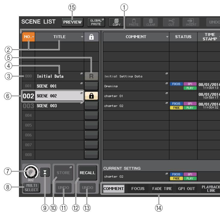
要启用 / 禁用场景保护设置，可以按下选定场景的 R 符号或保护图标。重复按下写保护（锁头）图标或 R（只读）图标可以在显示和隐藏对应图标之间进行切换。
