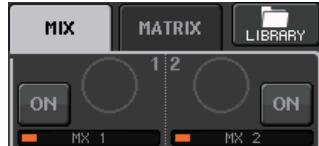
会出现灰色圆圈，而不是 TO MIX SEND LEVEL 旋钮，此时不能调节发送电平。
