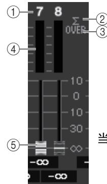
当通道 7 的 [ON] 键被打开, 通道 8 的 [ON] 键被关闭
