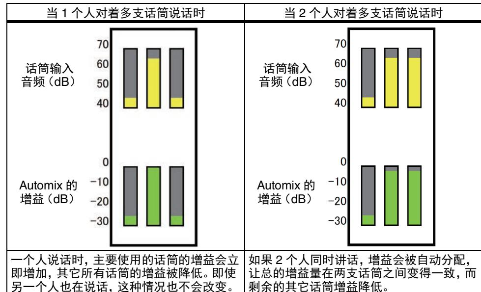
Dugan 演讲系统与限制器或自动电平控制器的功能是不同的。多人发言时，调音师可以用推子正常调节每个人的音量。即使没有人说话，系统也会搜索话筒音频并自动分配增益。因此，推子可以放心地置于推起的位置。
