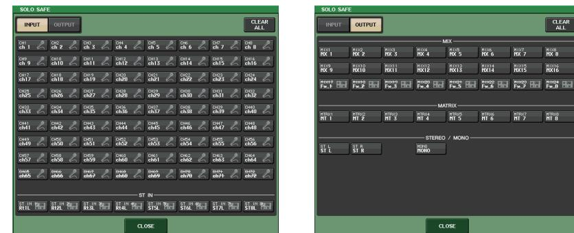
在此可指定将要从独奏操作中排除的通道。（可以指定一个以上。）当 SOLO 模式启用时，在此选择的通道将不会被静音。例如，当您需要保护某个通道，如需要发送信号至外部录音机的主 STEREO 通道和 MIX 通道，以防这些通道意外被设成 SOLO 模式时，该功能非常方便。
