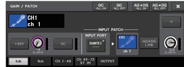
按下 INPUT PORT 按钮，在 PORT SELECT 窗口选择连接 AXT400 输出信号（OMNI 1）的端口。
