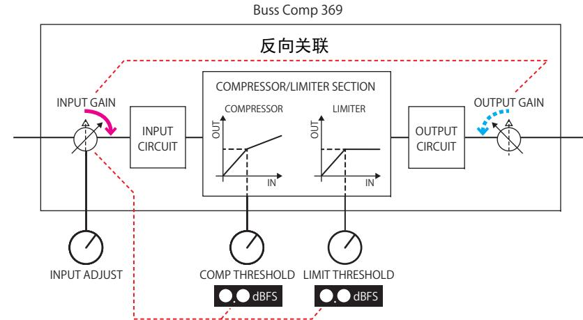
由于阈值发生了本质的变化，所做变化显示数值会被关联。但 COMPRESSOR/LIMITER SECTION 的内部条件不会实际改变。
