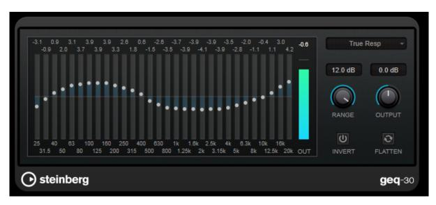
Jedes Frequenzband kann um 12 dB gedämpft oder verstärkt werden, was eine Feineinstellung der Frequenzbereiche ermöglicht. Zusätzlich sind mehrere Preset-Modi verfügbar, die dem Klang von GEQ-30 Farbe hinzufügen.
