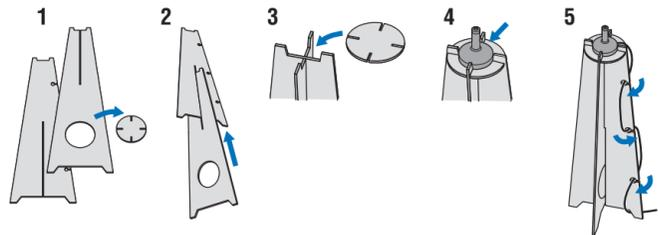
Wir empfehlen die Verwendung des mitgelieferten Pappstativs oder eines Stativs, um das IntelliBeam-Mikrofon in normaler Ohrenhöhe an der Hörposition aufzustellen.
