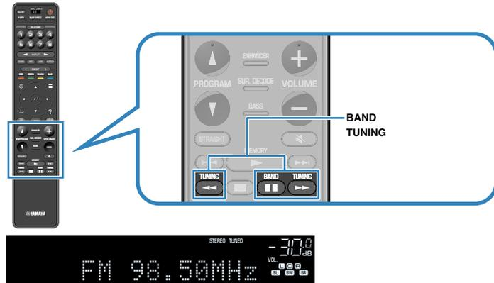
„TUNED“ leuchtet im Frontblende-Display auf, wenn das Signal eines FM-/AM-Senders empfangen wird.
