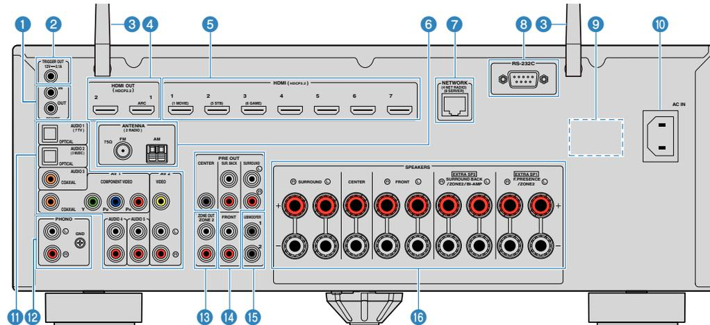
• Der Bereich um die Video-/Audio-Ausgangsbuchsen ist am Produkt selbst weiß markiert, um Falschanschlüsse zu vermeiden.
