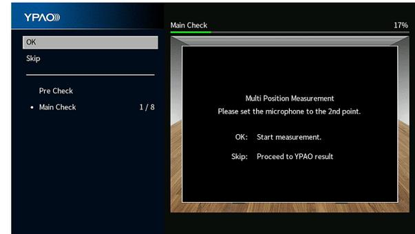
Platzieren Sie das YPAO-Mikrofon an der nächsten Hörposition und drücken Sie ENTER. Wiederholen Sie den Vorgang danach, bis an allen Hörpositionen (bis zu 8) eine Messung genommen wurde. Wenn die Messungen an den gewünschten Positionen abgeschlossen sind, verwenden Sie die Cursortasten zur Auswahl von „Überspringen“ und drücken ENTER.
