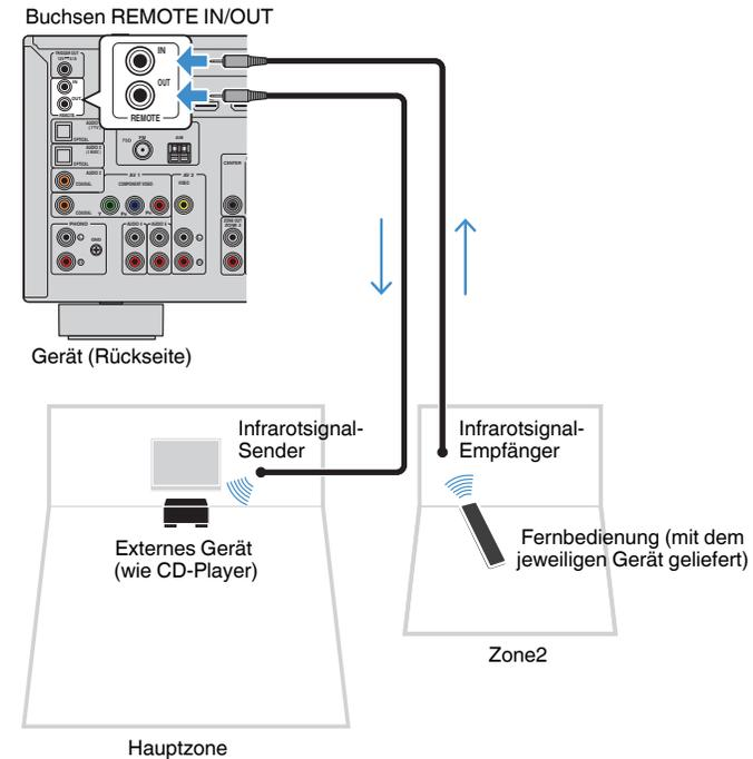
Ein Infrarotsignal-Sender wird nicht benötigt, wenn Sie Yamaha-Produkte verwenden, die wie dieses Gerät Fernverbindungen unterstützen. Sie können Fernbedienungssignale senden, indem Sie die Buchsen REMOTE IN/OUT über Kabel mit Mono-Miniklinkensteckern mit einem Infrarotsignal-Empfänger verbinden.
