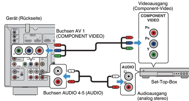
**1** Drücken Sie INPUT zur Auswahl von „AV 1“ (zu verwendende Video-Eingangsbuchse) als Eingangsquelle.
