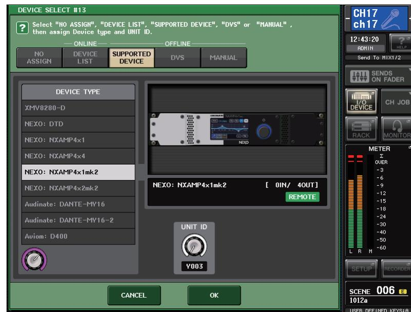
L'indicatore (**REMOTE**) viene visualizzato nel dispositivo che supporta il controllo remoto. Il modello NXAMPmk2 supporta il controllo remoto con la scheda Dante (NXDT104mk2).
