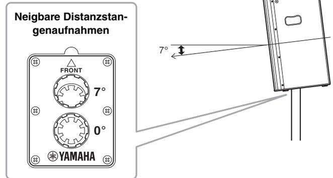
Es stehen zwei Distanzstangenaufnahmen zur Verfügung. Sie können den Winkel des Lautsprechers so wählen, dass er waagrecht zum Boden oder um 7 Grad zum Boden geneigt angebracht ist.
