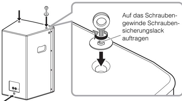
Zum Anbringen der Augenschrauben die werkseitig angebrachten Flachkopfschrauben entfernen und die Augenschrauben mit den Unterlegscheiben versehen.
