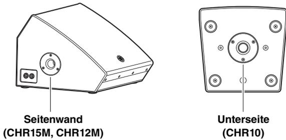
Diese Distanzstangenaufnahme ist kompatibel mit handelsüblichen Lautsprecherstativen und Lautsprecherdistanzstangen mit einem Durchmesser von 35 mm.
