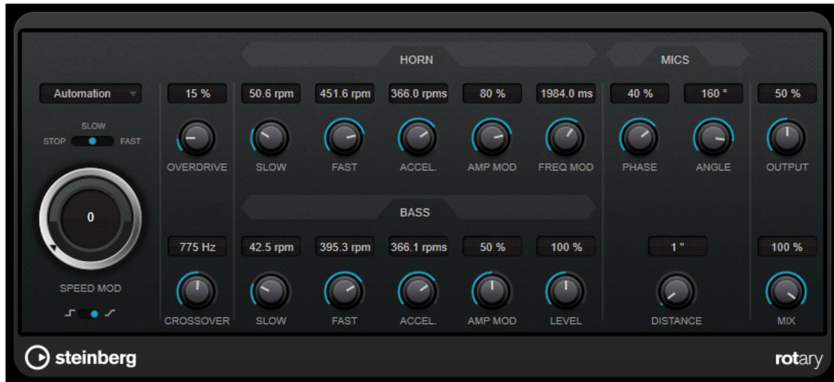
Bei diesem Effekt rotieren die Lautsprecher mit variabler Geschwindigkeit, wodurch ein Chorus-Effekt entsteht, wie er oft für Orgelklänge eingesetzt wird.
