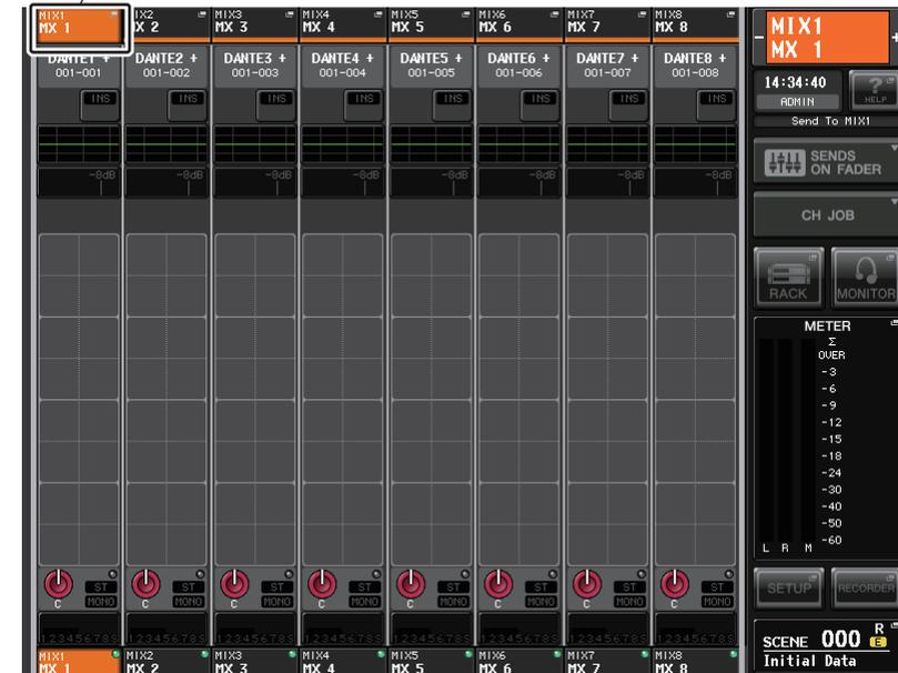
2. Rufen Sie das PATCH/NAME-Einblendfenster auf, indem Sie das Kanalnummern-/Kanalnamenfeld des Kanals drücken, dem Sie den Kanalnamen und das Symbol zuordnen möchten.
