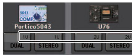
Der U76 belegt zwei HE im Rack. Andere Prozessoren belegen 1 HE im Rack. Wenn Sie einen Premium-Rack-Prozessor mit 2 HE im Rack montieren, können Sie unterhalb dieser HEs keine weiteren Prozessoren mehr montieren. Außerdem können Sie keinen 2-HE-Prozessor in Rack 8 montieren.
