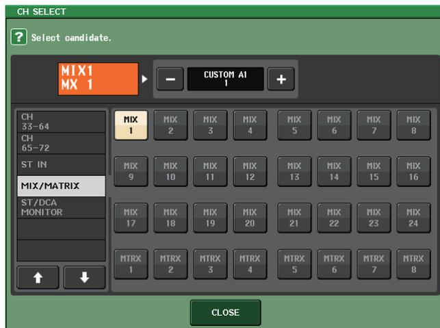
Verwenden Sie für die Auswahl der gewünschten Kanalgruppe die Liste in der linken Spalte und verwenden Sie anschließend zur Auswahl der Kanäle die Schaltflächen in der rechten Spalte. Wenn Sie die Kanalauswahl vorgenommen haben, drücken Sie auf die CLOSE-Schaltfläche.
