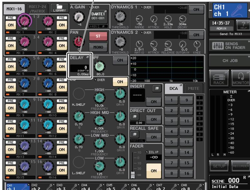
3. Drücken Sie auf das Feld INPUT DELAY, um das Einblendfenster INPUT DELAY (Eingangsverzögerung) zu öffnen.
