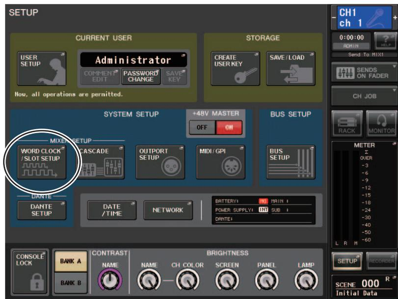
2. Drücken Sie im **SYSTEM-SETUP**-Feld in der Bildschirmmitte auf die Schaltfläche **WORD CLOCK/SLOT SETUP**, um das Einblendfenster **WORD CLOCK/SLOT SETUP** zu öffnen.
