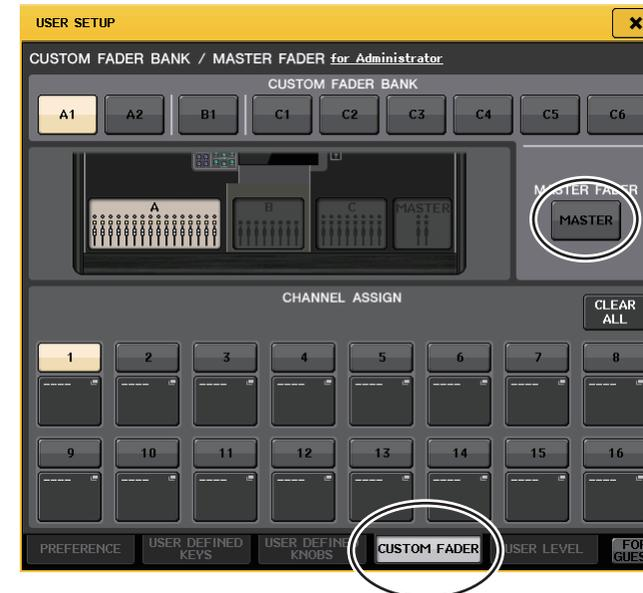
3. Drücken Sie auf die CUSTOM-FADER-Registerkarte, um die Seite CUSTOM FADER BANK/MASTER FADER aufzurufen.
