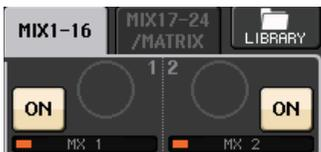
Wenn der als Send-Ziel dienende MIX-Bus vom Typ VARI ist oder wenn der als Send-Ziel dienende Bus ein MATRIX-Bus ist, wird der TO-MIX-SEND-LEVEL-Regler in der gleichen Farbe wie der entsprechende Regler im SELECTED-CHANNEL-Bereich dargestellt. In diesem Fall können Sie den entsprechenden Regler im SELECTED-CHANNEL-Bereich zur Einstellung des Send-Pegels verwenden.
