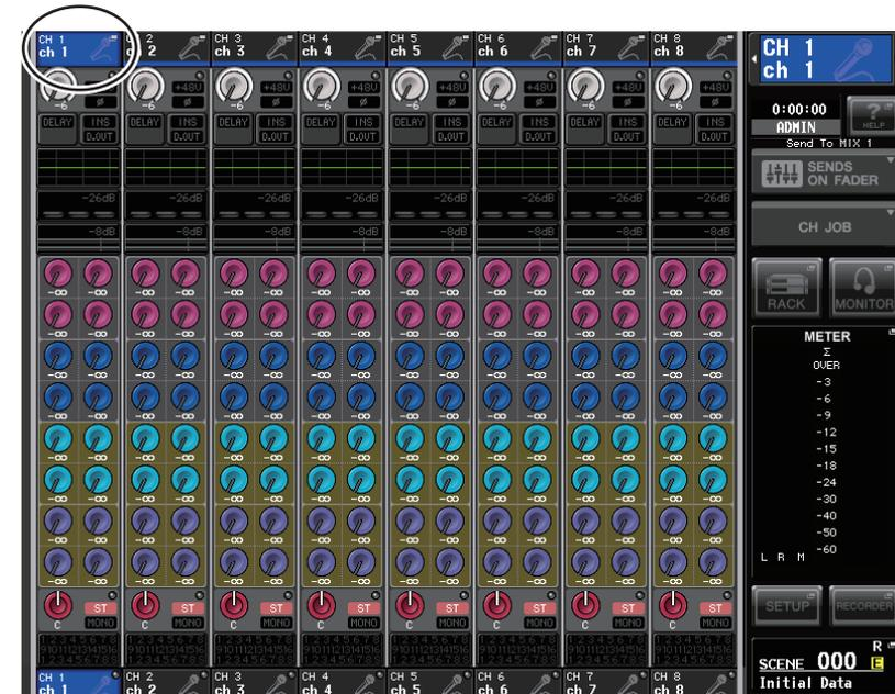
2. Drücken Sie im oberen Bildschirmbereich auf das Feld mit der Kanalnummer bzw. dem Kanalnamen, um das Einblendfenster PATCH / NAME zu öffnen.
