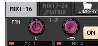
Bei einem MONO-Kanal stellt der rechte Regler den gemeinsamen Send-Pegel an die beiden MIX/MATRIX-Busse ein und der linke das Panorama zwischen den beiden MIX/MATRIX-Bussen. Wenn Sie den linken TO-MIX/MATRIX-SEND-LEVEL-Regler gegen den Uhrzeigersinn drehen, erhöht sich der Signalanteil, der an den ungerade nummerierten MIX/MATRIX-Bus gesendet wird, und durch Drehen im Uhrzeigersinn erhöht sich der Signalanteil, der an den gerade nummerierten MIX/MATRIX-Bus gesendet wird.
