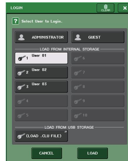
3. Wählen Sie im LOAD FROM INTERNAL STORAGE-Feld den Benutzerauthentifizierungsschlüssel, mit dem Sie sich anmelden wollen, und drücken Sie die LOAD-Schaltfläche.
