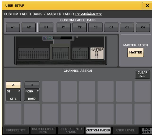
5. Drücken Sie für den Fader, den Sie bearbeiten wollen, auf die Einblendschaltfläche für die Fader-Zuweisung.
