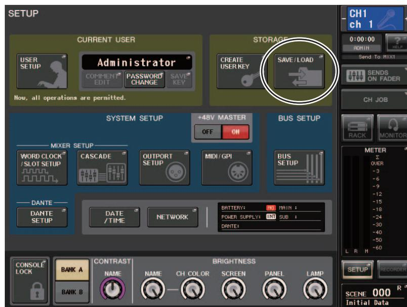
2. Drücken Sie auf die SAVE/LOAD-Schaltfläche, um das SAVE/LOAD-Fenster zu öffnen.
