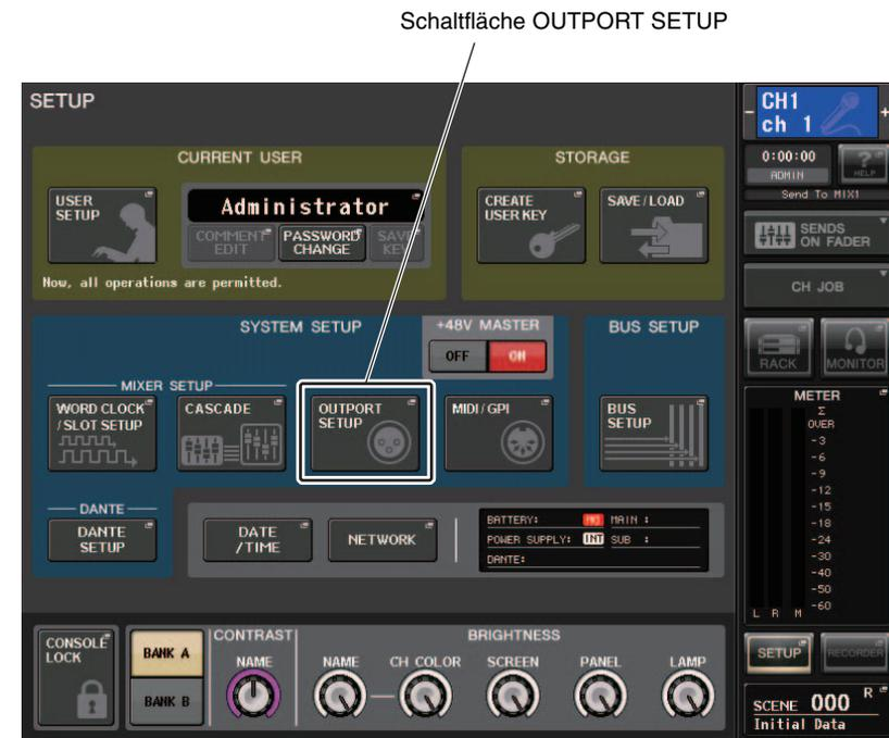
2. Drücken Sie in dem in der Bildschirmmitte angeordneten Feld SYSTEM SETUP auf die Schaltfläche OUTPUT SETUP, um das OUTPUT-PORT-Einblendfenster zu öffnen.
