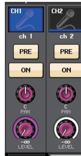
Wenn die Send-Quelle stereo ist, können Sie die PAN/BALANCE-Moduseinstellung im TO-STEREO/MONO-Einblendfenster verwenden, um auszuwählen, ob PAN/BALANCE als PAN- oder BALANCE-Regler fungiert.
