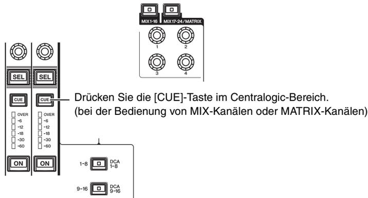
Drücken Sie die [CUE]-Taste im Centralogic-Bereich. (bei der Bedienung von MIX-Kanälen oder MATRIX-Kanälen)
