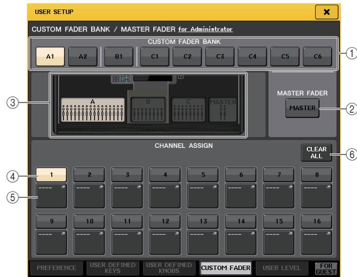
3. Drücken Sie auf die **CUSTOM-FADER-Registerkarte**, um die Seite **CUSTOM FADER BANK/MASTER FADER** aufzurufen.
