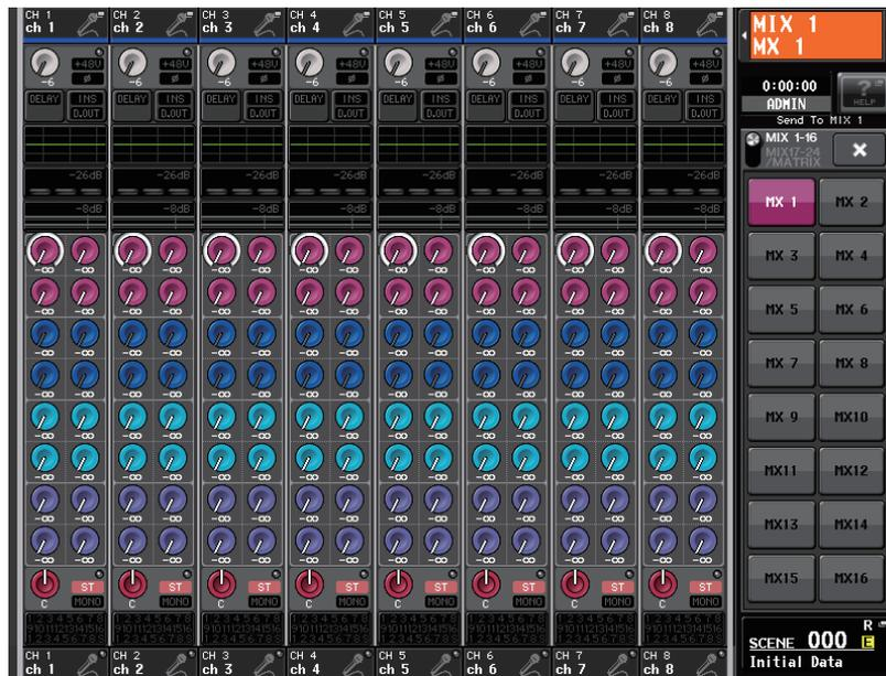
3. Drücken Sie mehrmals die MIX/MTRX-ON-FADER-Umschaltfläche, um MIX1-16 oder MIX17-24/MATRIX auszuwählen.
