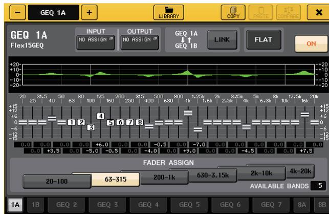
Dieses Fenster entspricht dem für den 31BandGEQ, außer dass im Parameterfeld AVAILABLE BANDS die Echtzeitanzahl verfügbarer Bänder (maximal 15) angezeigt, die im aktuellen GEQ eingestellt werden können.
