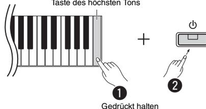
Die Kontrolllampen [●] und [▶/■] blinken und geben damit an, dass die Initialisierung ausgeführt wird. Nach Abschluss des Vorgangs erlöschen beide Anzeigen.
