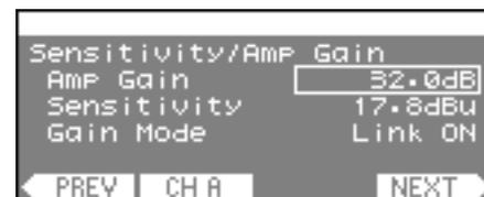
3. Verwenden Sie Encoder A, um den Cursor auf Amp Gain oder Sensitivity zu bewegen, und Encoder B zur Einstellung des Parameterwertes.
