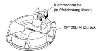
**2. Bringen Sie die einzelnen Pads an den zugehörigen Stangen an, und ziehen Sie dann die Klemmschraube fest, um das Pad zu befestigen.**
