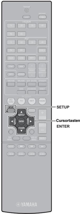
**6** Verwenden Sie die Cursortasten ( $\triangle/\nabla$ ) zur Auswahl von „Wi-Fi-Einst. teilen (iOS)“, und drücken Sie ENTER.
