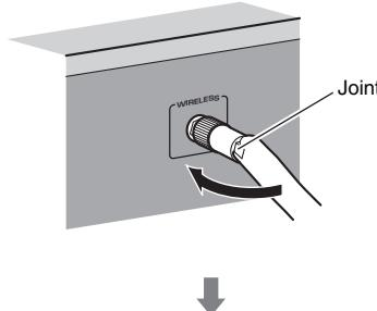
Tournez dans le sens des aiguilles d'une montre vers la position verticale
