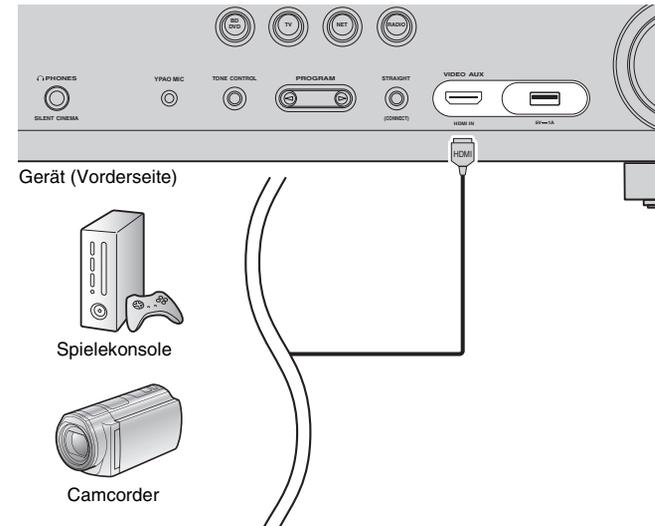
Wenn Sie die Eingangsquelle „V-AUX“ durch Drücken von V-AUX auswählen, werden die am Videogerät abgespielten Video-/Audiosignale am Gerät ausgegeben.
