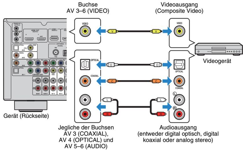
Wenn Sie die Eingangsquelle durch Drücken von AV 3-6 auswählen, werden die am Videogerät abgespielten Video-/Audiosignale vom Gerät ausgegeben.
