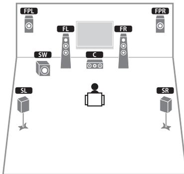
Dieses Lautsprechersystem verwendet die vorderen Präsenzlautsprecher zur Erzeugung eines natürlichen, dreidimensionalen Schallfelds und erzeugt außerdem Virtual Surround Back Speaker (VSBS), indem es über die Surround-Lautsprecher dem hinteren Schallfeld mehr Klangtiefe verleiht. Dieses System eignet sich sowohl für den Genuss von 5.1-Kanal- als auch 7.1-Kanal-Inhalte.
