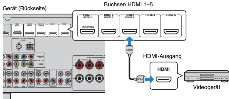
Wenn Sie die Eingangsquelle durch Drücken von HDMI 1–5 auswählen, werden die am Videogerät abgespielten Video-/Audiosignale vom Gerät ausgegeben.
