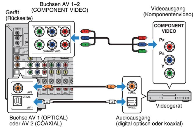
Wenn Sie die Eingangsquelle durch Drücken von AV 1–2 auswählen, werden die am Videogerät abgespielten Video-/Audiosignale vom Gerät ausgegeben.
