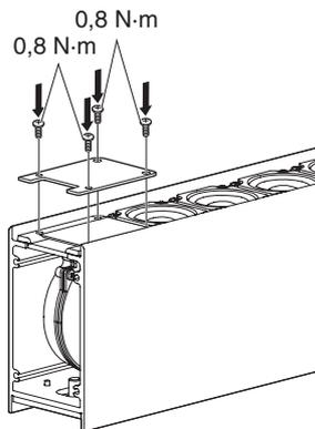
(Für VXL1-8) Setzen Sie den Block in den Bassreflexkanal ein und positionieren Sie dann die Portabdeckung und befestigen Sie sie mit den gelösten Schrauben.
