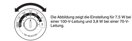
Die Abbildung zeigt die Einstellung für 7,5 W bei einer 100-V-Leitung und 3,8 W bei einer 70-V-Leitung.
